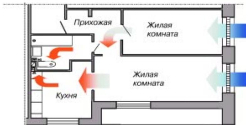
Рис.5. Пример расположения приточных устройств в двухкомнатной квартире с зонированием помещений по чистоте воздуха
