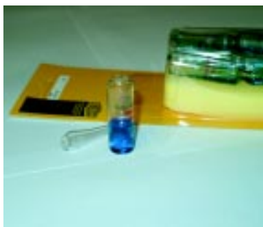
Определение кислотности масла. Изменение цвета индикатора с синего на желтый говорит о необходимости замены масла.
