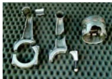
Сломанные шатуны и поршни компрессора чиллера.
