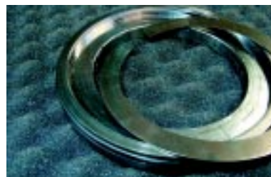
На всасывающем клапане видны следы сильного наклепа, волновые пружины лопнули в нескольких местах.
